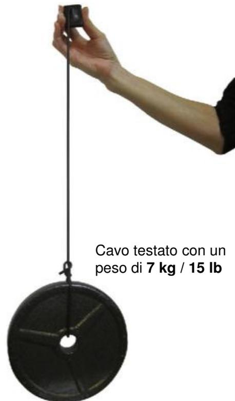
Cavo testato con un peso di **7 kg / 15 lb**
